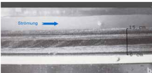
Abb. 9: Längsschnitt eines Schwemmrinnenexperiments mit farblich gekennzeichneten Sanden unterschiedlicher physikalischer Eigenschaften
