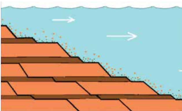
Abb. 8: Schematische Darstellung der Laborergebnisse zur Bildung von Sedimentablagerungen in Form von parallelen Schichten bei horizontaler Wasserströmung. Die mechanische Sortierung von Partikeln erfolgt aufgrund von unterschiedlicher Größe oder unterschiedlicher Dichte.
